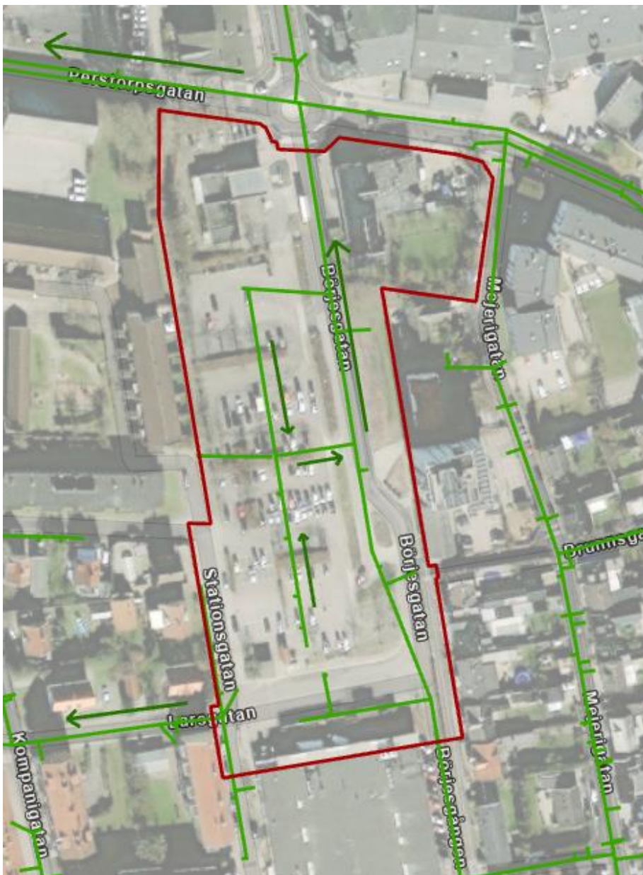
Figur 8. Befintligt dagvattensystem inom och i anslutning till planområdet
