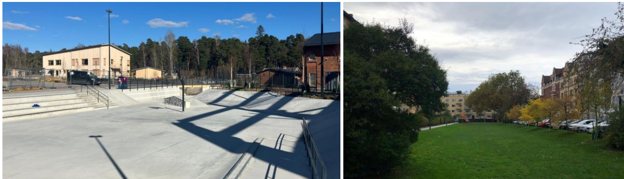
Figur 18. Exempel på nedsänkta ytor för som kan nyttjas för fördröjning av dagvatten
