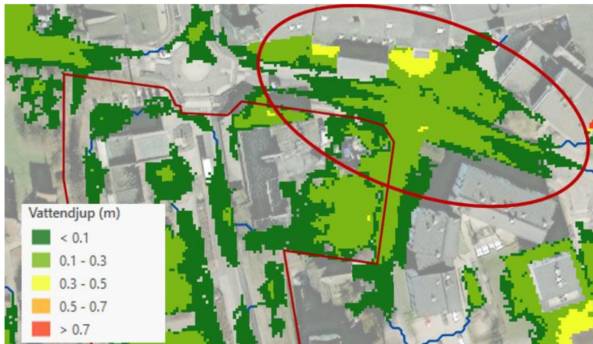
Figur 21. Befintlig lågpunkt nordöst om kvarter 5 som riskerar översvämning vid skyfall
