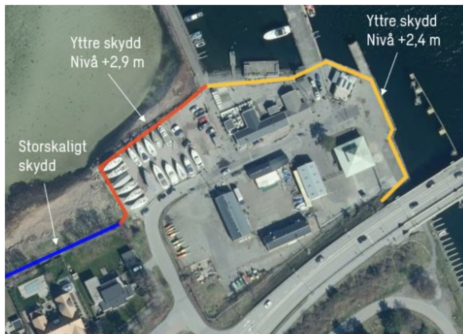
Förslaget yttre skydd för översvämning mot hav tillsammans med dimensionerande nivåer år 2075. Källa Sweco.
