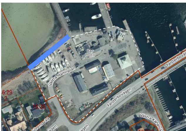
Figur 2. Blå linje visar kuststräcka där det bedöms finnas en påverkan från lokala effekter i form av våguppstuvning och våguppspolning.
