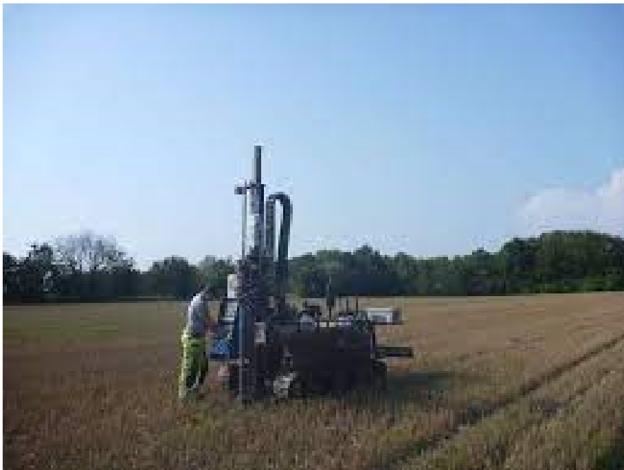
Figur 2. Provtagning med skruvborr monterad på bandvagn.
