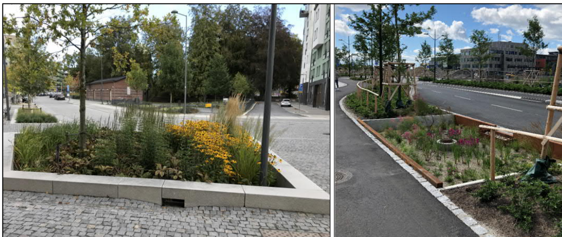
Figur 11. Exempel på nedsänkta regnbäddar (Foton: Norconsult)
