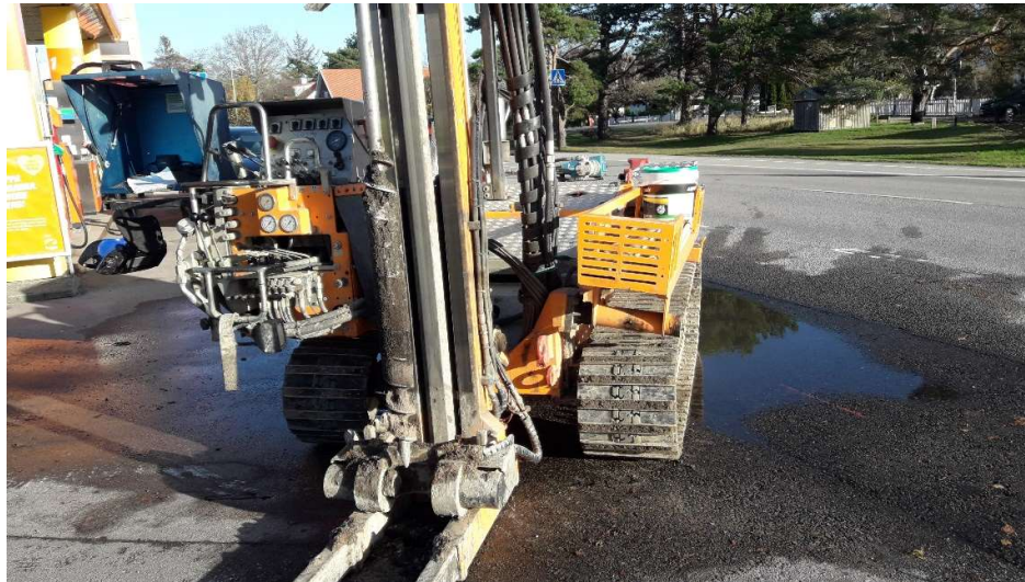
Figur 2. Provtagning med skruvborr monterad på bandvagn.
