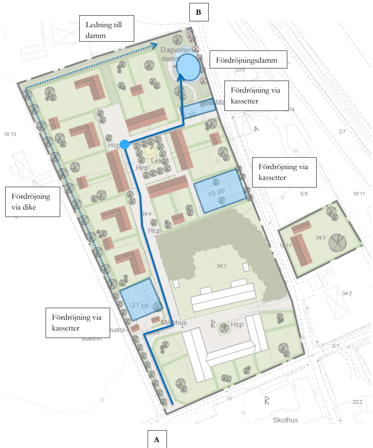
Illustration av dagvattenhanteringen genom området med olika lösningar som dike, fördröjning via kassett och via damm.
