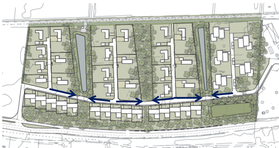
Figur 1.7: Övan ges en schematisk bild över föreslaget dagvattensystem inom planområdet med fördröjningsmagasin och lågstråk utmarkerade. Nedan ges en illustration av planområdet där placeringen av flerbostadshus och fördröjningsmagasinens utformning förändrats något (Sweco 2014, 2015a).
