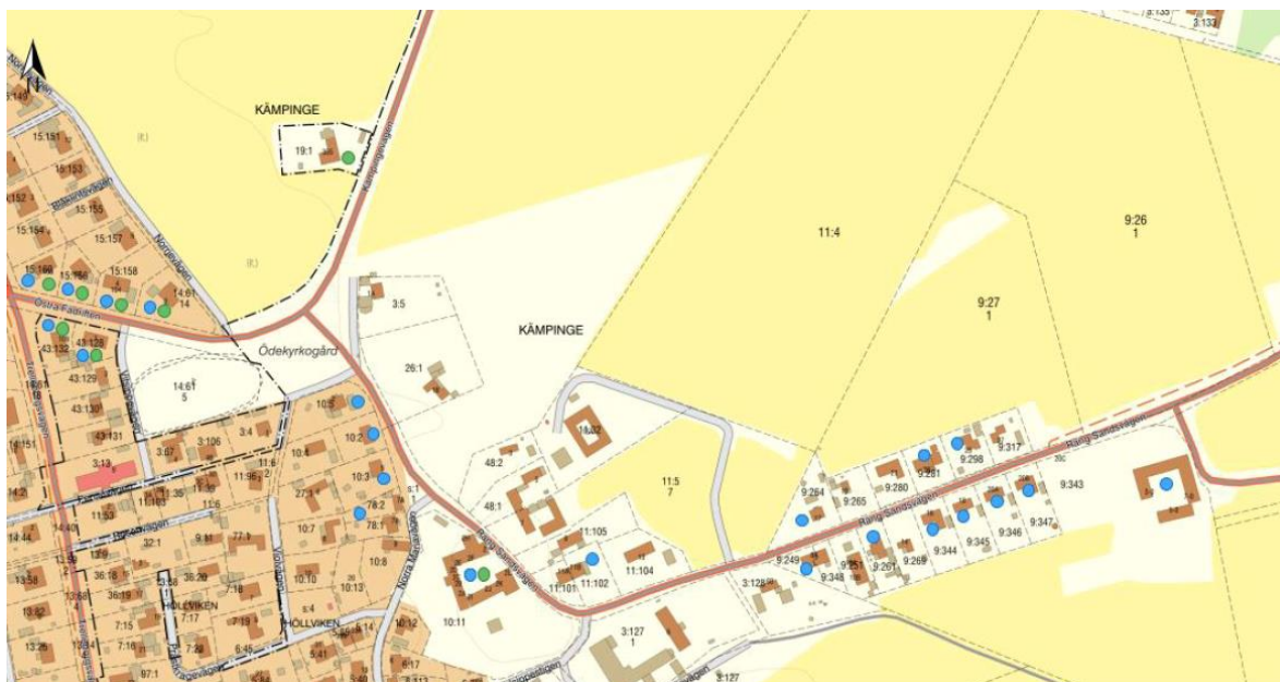
Figur 23. Utsnitt från bullerutredning (WSP, 2023-06-09). Blå prick markerar fastigheter som överskrider riktvärde för fasad vid ekvivalent ljudnivå för nollalternativet. Grön prick markerar fastigheter som överskrider riktvärde för fasad vid ekvivalent ljudnivå för alternativet med vägutbyggnad.
