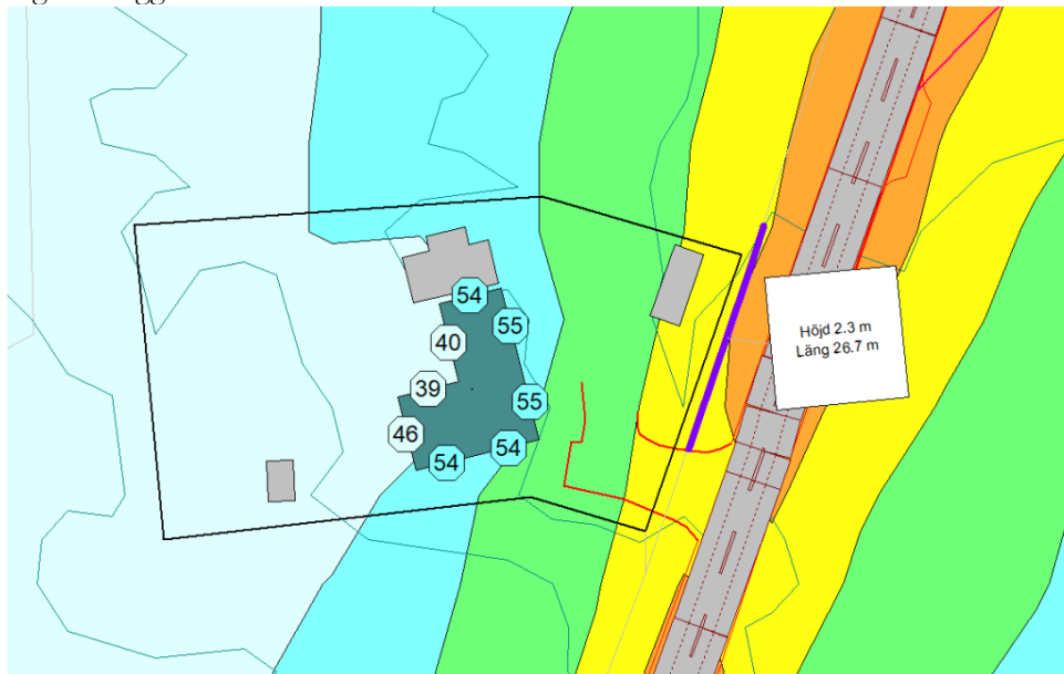
Figur 26. Utsnitt ur bullerutredningen, WSP 2023-06-09, förslag på bullerskyddande åtgärd för fastighet Kämpinge 19:1
