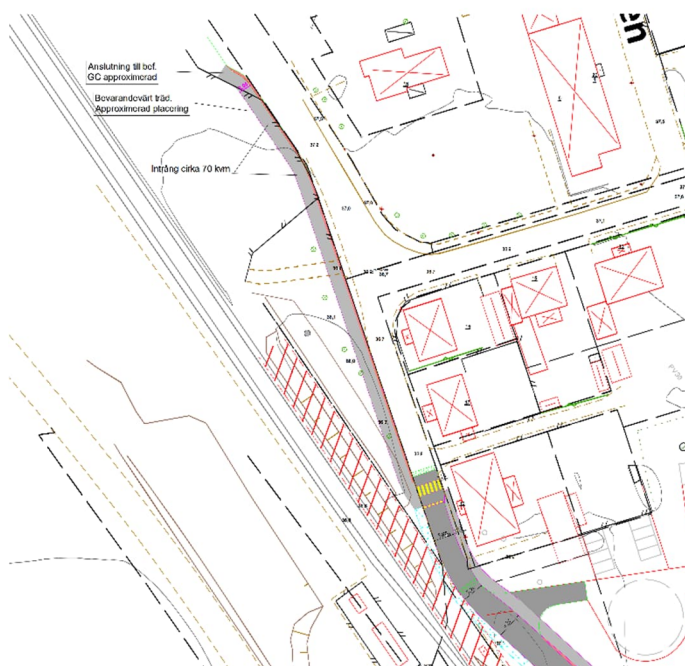
Figur 16 Förlängning av befintlig gång- och cykelbana utmed Stationsvägen.
