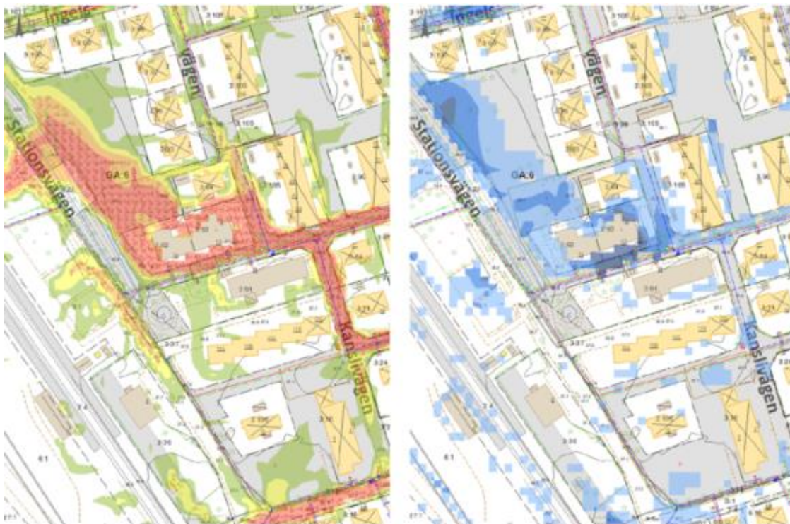
Kartan till vänster visar flödet av regnvatten och kartan till höger visar översvämningszoner vid ett 100 års regn.
