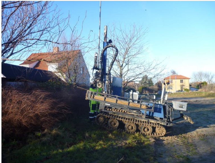
Figur 3. Provtagning med skrubborr monterad på bandvagn.
