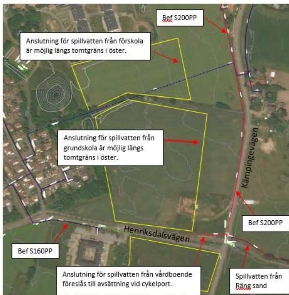
Figur 5 Möjliga anslutningspunkter för spillvatten.
