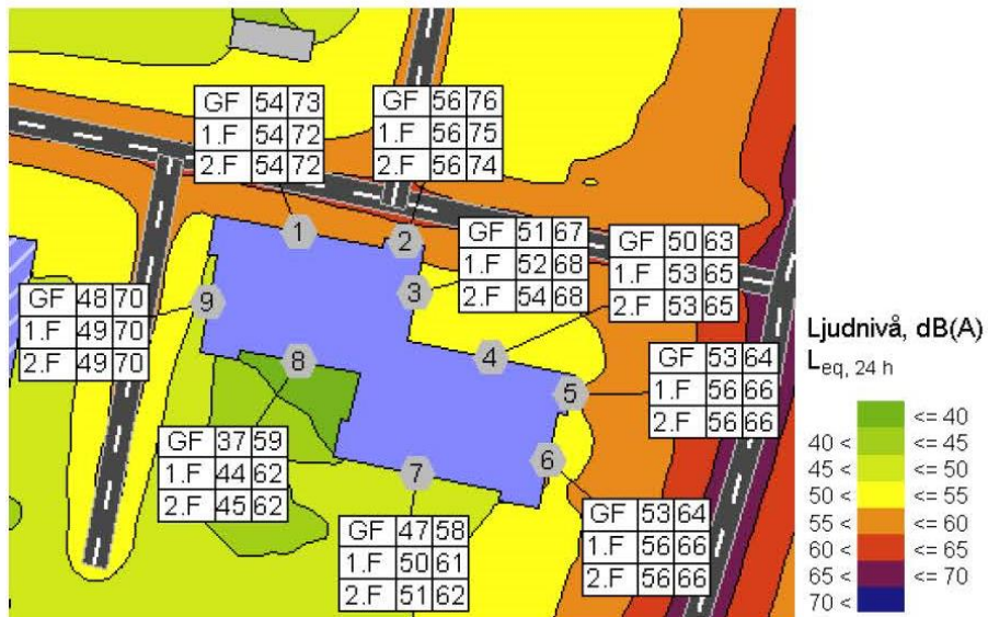
Ekivalent samt maximal ljudnivå vid fasad – kartbilden visar att inga riktvärden vid fasad överskrids. Mittenkolumn i tabell visar ekvivalent nivå, sista kolumnen maximal nivå. GF=1 vån (markplan), 1F=2:a vån, 2F=3 vån. ). Beräknade ljudnivåer utgår från ett framtida scenario år 2040. (Ramböll)
