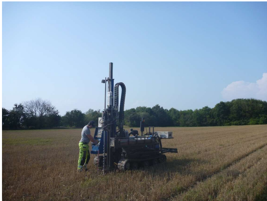
Figur 2. Provtagning med skruvborr monterad på bandvagn.
