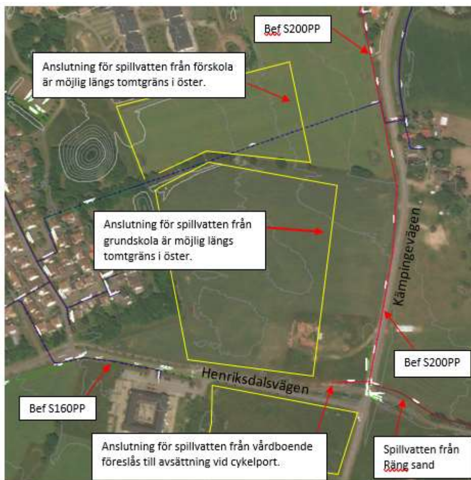
Figur 5 Möjliga anslutningspunkter för spillvatten.
