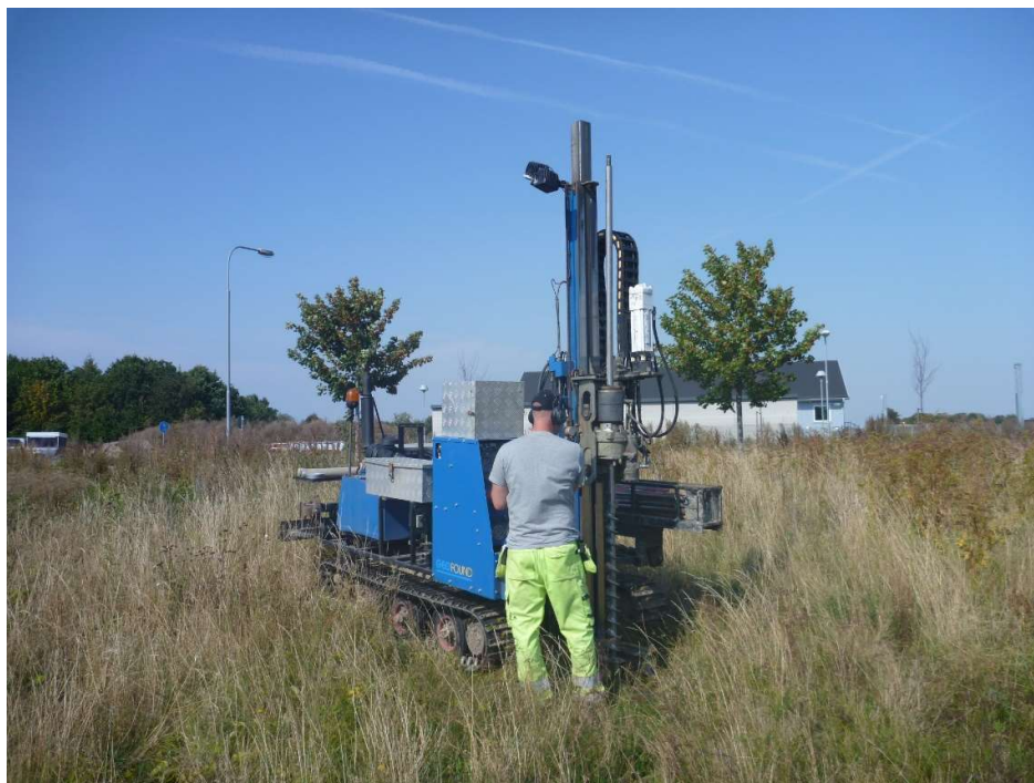
Figur 2. Provtagning med skruvborr monterad på bandvagn.
