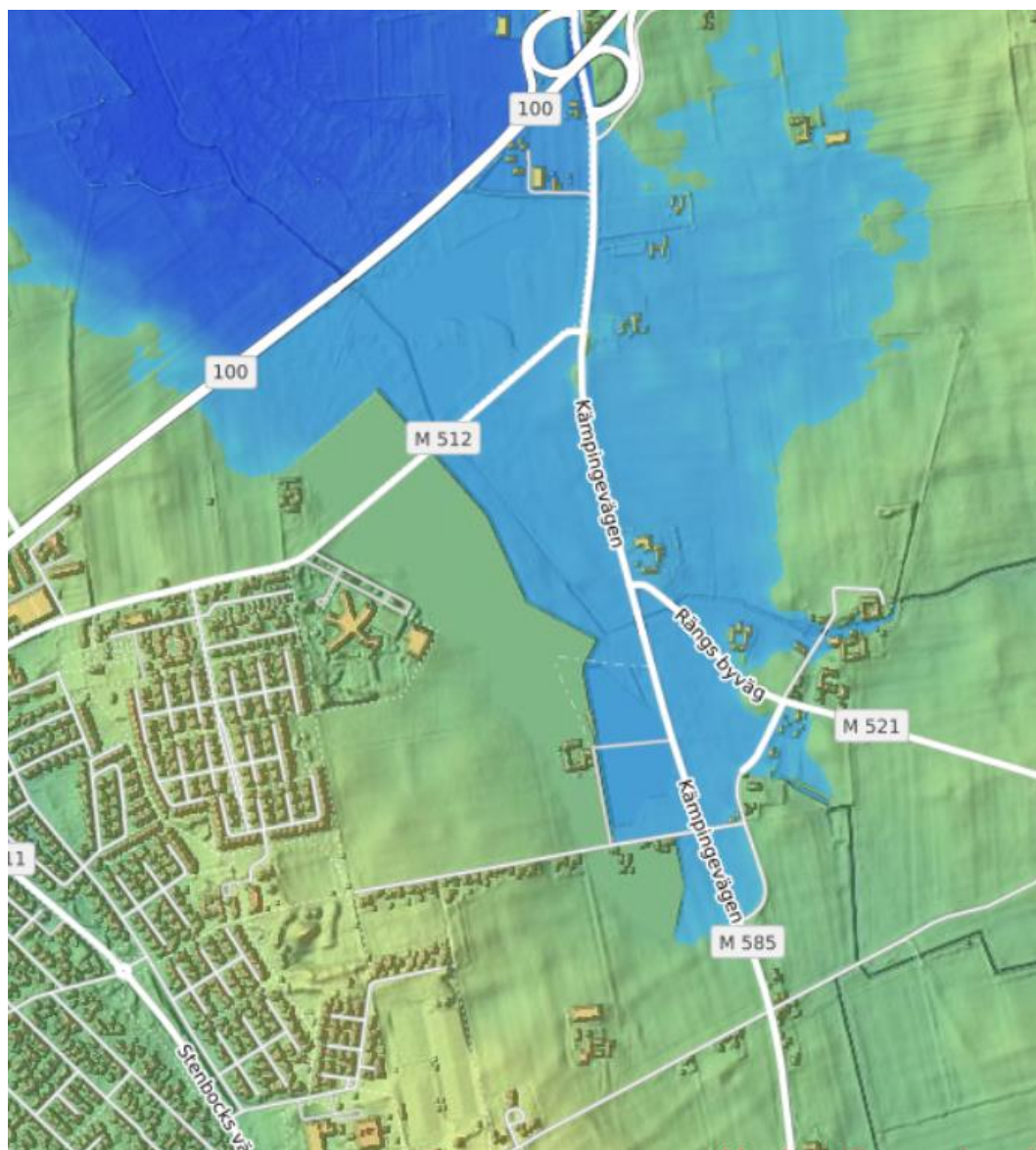
Figur 7 Höjdmodell över området där marknivån inom det bebyggda området höjts upp till +3,0 m (RH2000). Blå områden visar översvämningsutbredning vid havsnivå +3,0 att jämföra med figur 1. Bilden är ett skärmbild från SCALGO Live.
