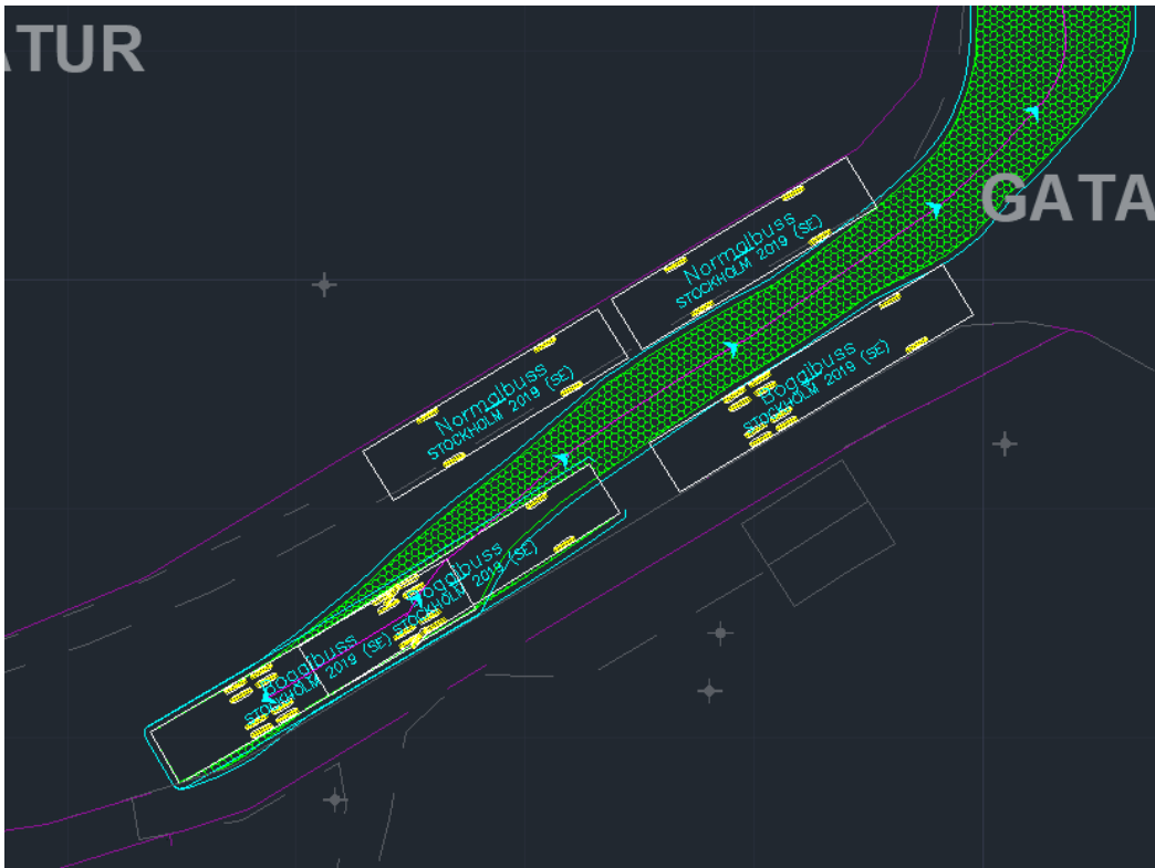
Figur 33. Körspårsanalys av kollektivtrafikbuss som angör rastplatsen, för att sedan köra förbi parkerad kollektivtrafikbuss samt turistbuss (normalbuss).
