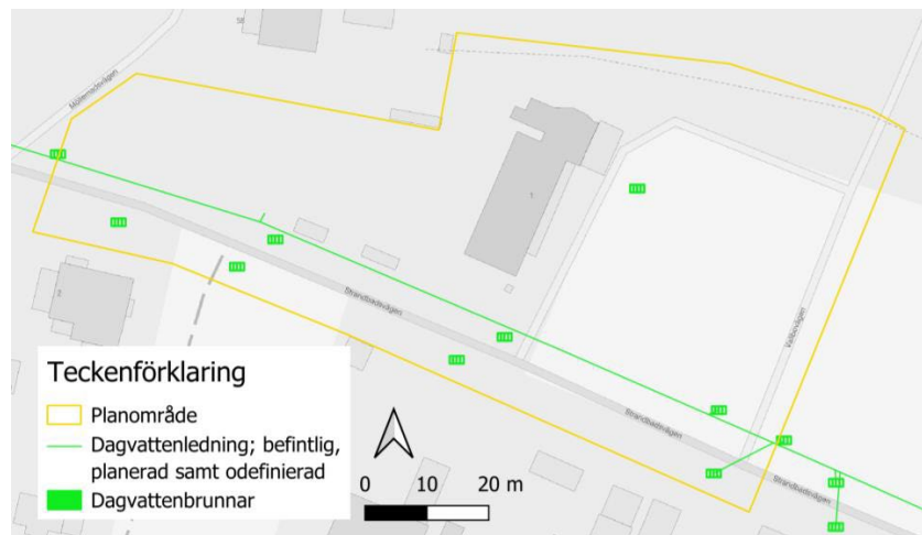
Fig. 25. Befintligt dagvattensystem för planområdet. (Sweco)
