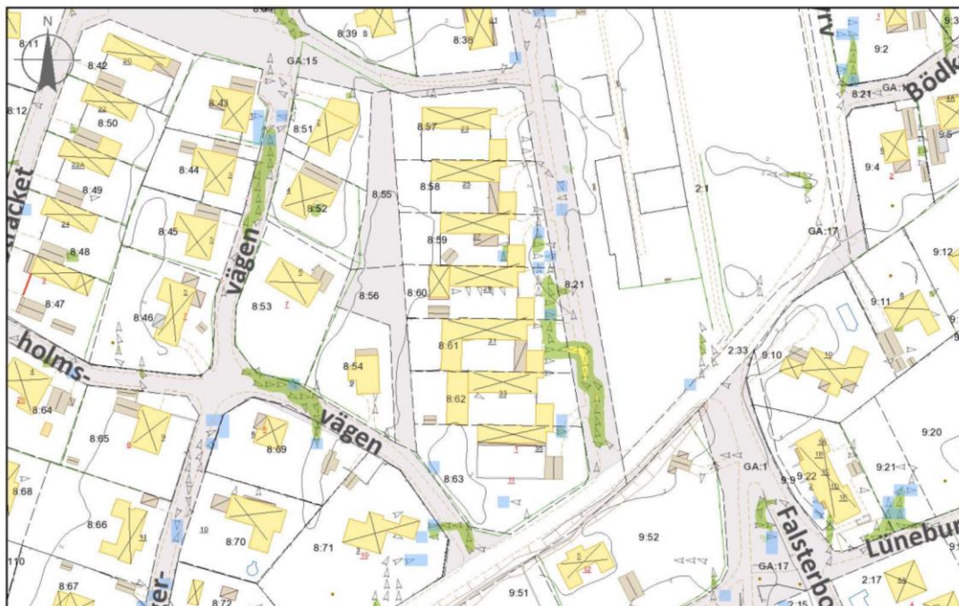
Utdrag från baskarta med kommunens skyfallskartering utförd 2017. Karteringen visar flöden (gröna och gula) och stillastående vatten (blå) vid 100-årsregn. De gröna och blå kulörerna representerar den första graden på en 3-gradig skala, den gula kulören den andra graden. Planområdet mitt i bild.
