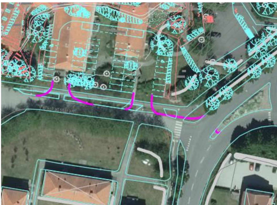
Figur 19. Föreslagen breddning av Verkstadsgatan i anslutning mot Norrevångsgatan. Rosa linjer visar förslag på justering samt föreslagen placering av anslutningarna till Eskilsgården. Refugen inför cirkulationsplatsen föreslås kortas för att underlätta vänstersväng söderifrån för lastbilar.
