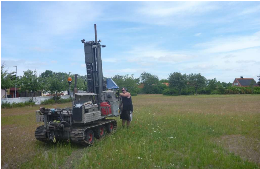
Figur 2. Provtagning med skruvborr monterad på bandvagn.
