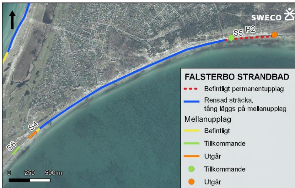
Figur 3-7 Rensade sträckor längs Falsterbo strandbad samt läge för tångupplag
