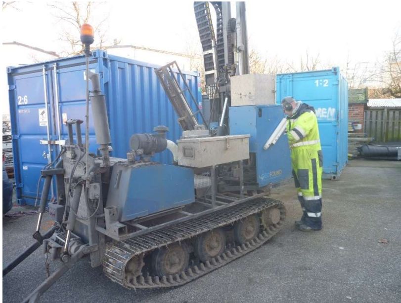
Figur 2. Provtagning med skruvborr monterad på bandvagn.
