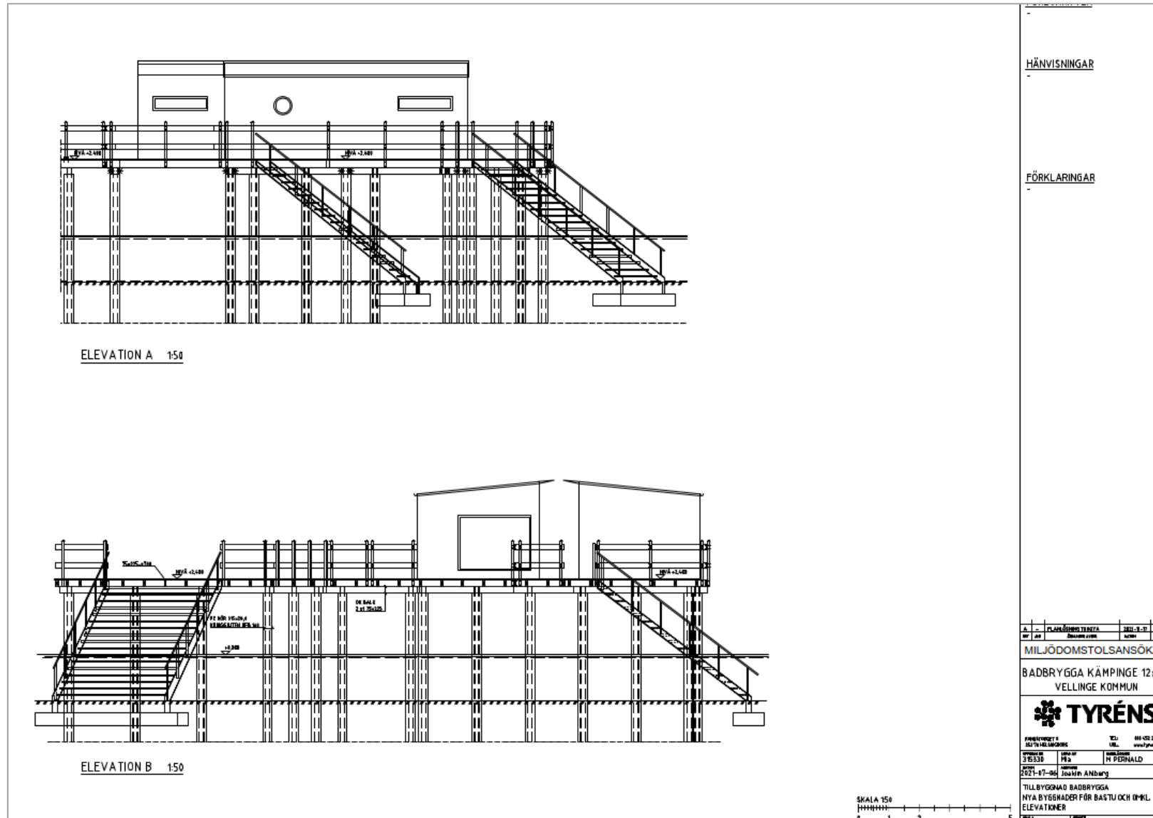
Figur 5-8 Profiltröning över planerad bastuplattform. Källa: Tyréns (2021)
