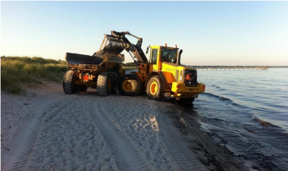
Figur 5-2 Rensning med hjullastare och gallerskopa
