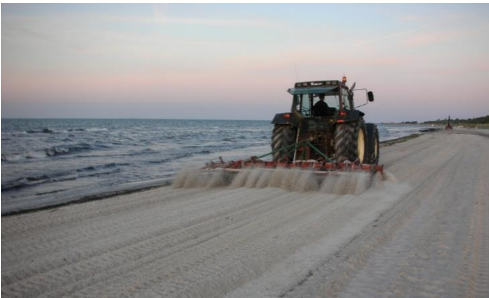
Figur 5-3 Sandhävning för att släta ut hjulspår
